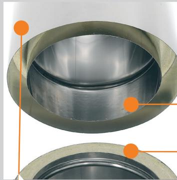
**1** Innenwand in direktem Kontakt mit dem Rauch, aus rostfreiem Austenitstahl des Typs AISI 316L, in einem zertifizierten Schweißverfahren laser- oder TIG-geschweißt.
