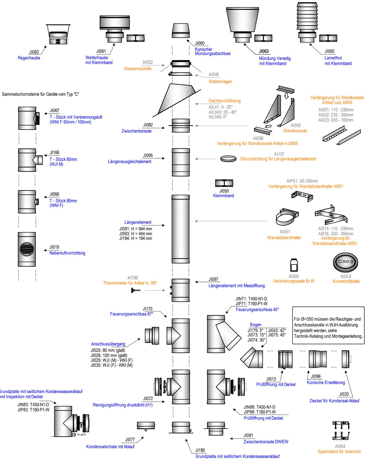
Für Ø>350 müssen die Rauchgas- und Anschlusskanäle in WJH-Ausführung hergestellt werden, siehe Technik-Katalog und Montageanleitung.
