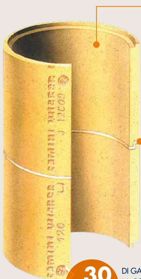
Condotto per l'evacuazione dei prodotti della combustione in atmosfera, tipologia CW ECO, costituito da elementi modulari in materiale refrattario, di sezione circolare, marcati CE in conformità alla norma EN 1457-1 e EN 1457-2.
