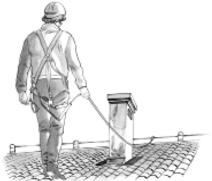
onde evitare cadute dall'alto. Nel caso di accesso dal basso questo può avvenire attraverso l'apertura di ispezione della camera di raccolta posta alla base oppure anche attraverso la disconnessione del condotto/canale da fumo.
