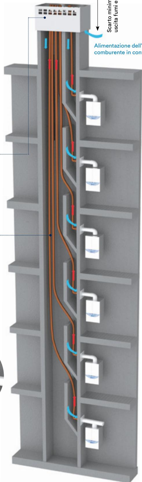
Camini Wierer esegue un controllo dimensionale per validare il passaggio dei condotti flessibili in PVDF nella canna fumaria esistente ed esegue il dimensionamento
